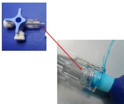
Figur 1: Potentiell plats för läckage vid trevägskranens hölje
