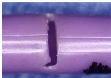
Bild 1: Exempel på spricka som går tvärs över/runt kateterkroppen
